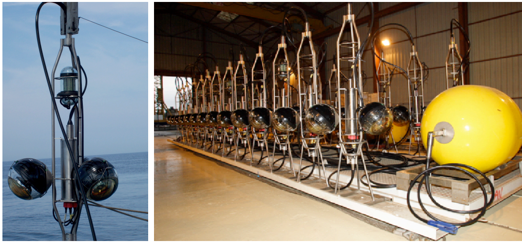
FIG. 2.11: A gauche : photographie d'un étage d'une ligne du télescope. On distingue les trois modules optiques. Au milieu des trois modules, dans le cylindre inférieur, se trouve le conteneur électronique (LCM). Au dessus, on distingue la balise de LED destinée aux étalonnages. A droite : photographie d'une ligne de détection dans le hall de montage, repliée sur une palette, avant immersion.
